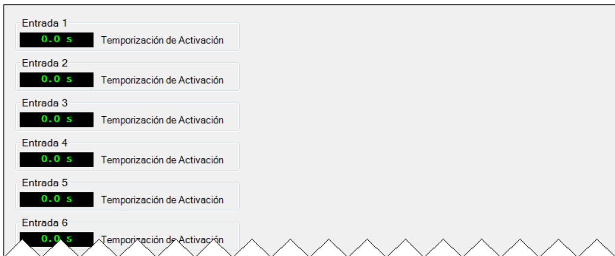
Figura 4-97. Temporizadores de entradas de contactos
