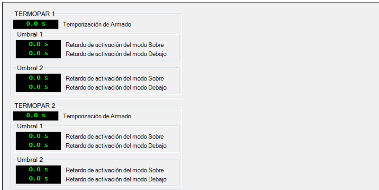
Figura 4-106. Temporizadores de Entradas de termopar remotas
